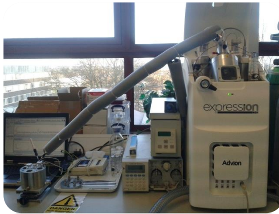
Aroma, koku ve orijin belirleme analizlerinde kullanılmak için vASAP probu
