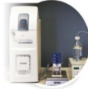
TLC Tabakalarından Direkt Kütle Analizi
