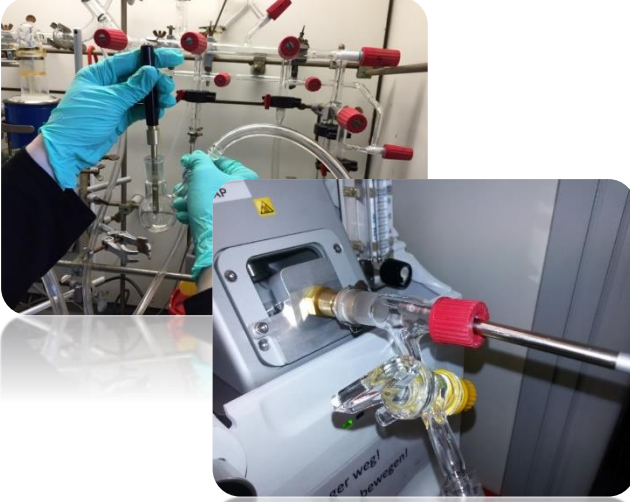
İnert ortamlarda analiz imkanı sunan iASAP probu
