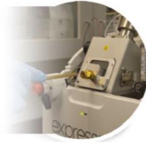
Katı ve Sıvı Numunelerin Direkt Analizi İçin Prob (ASAP)
