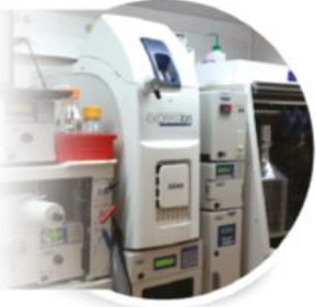
SFC ya da Prep-LC ile Saflaştırma
